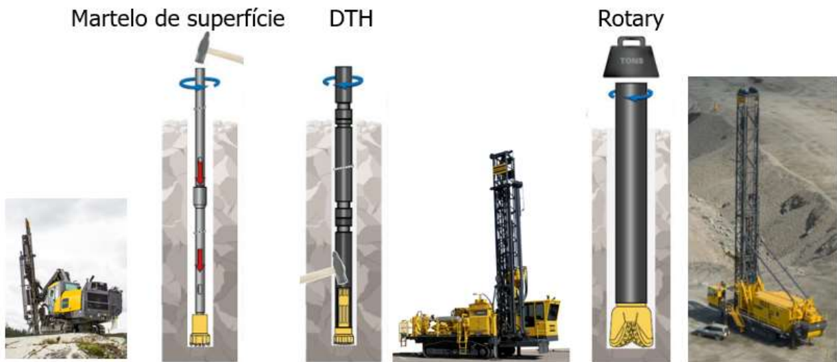
Figura 14 – Métodos de perfuração (Adaptado de EPIROC, 2018)
